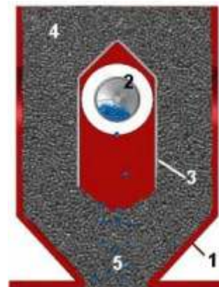
1. Směšovací krk 2. Dávkovací válec 3. Krycí plech 4. Přírodní materiál 5. Do výrobního stroje
